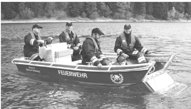
Anfang Oktober ist das neue Bezirksfeuerwehrboot eingetroffen. Es handelt sich hierbei um ein unsinkbares Motorboot in Aluminiumbauweise mit Führerstand und Außenbordmotor. Ein besonderes Kennzeichen dieses Bootes ist die Bugklappe, welche eine wesentliche Erleichterung für die Taucher beim Einstieg ins Boot darstellt.
