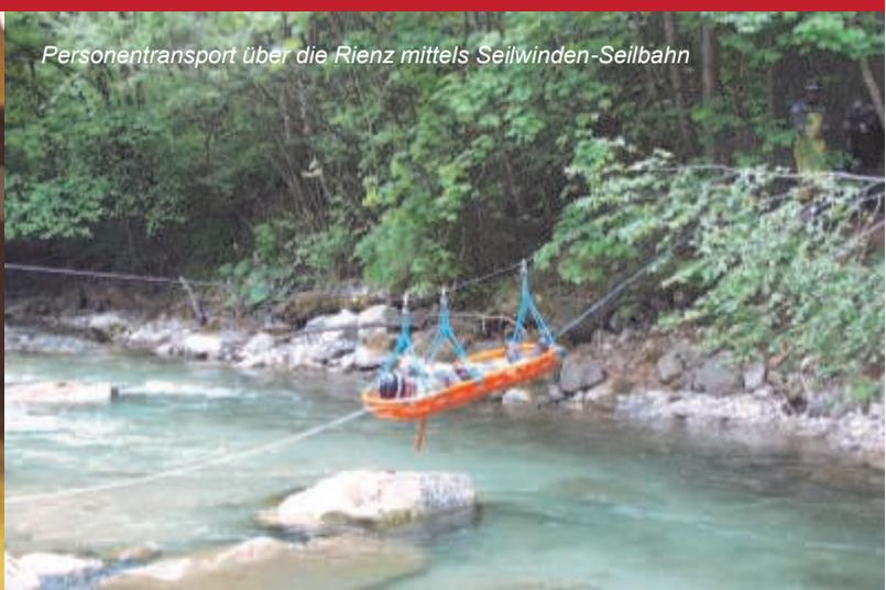
Personentransport über die Rienz mittels Seilwinden-Seilbahn
